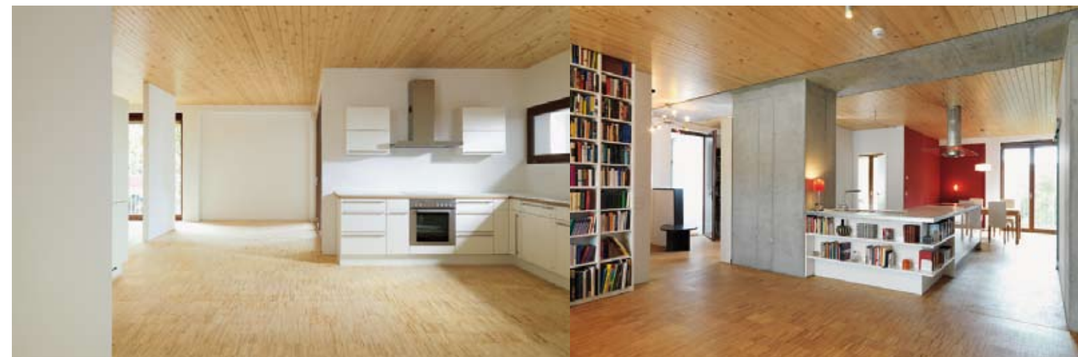
Côté aménagement intérieur, les architectes ont pris le parti d'exprimer le bois plus qu'à l'extérieur : la sous-face des panneaux de bois massif est ainsi laissée apparente.
